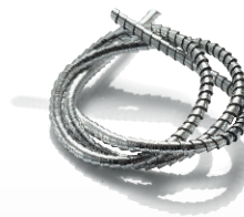
vorher Spanbildung mit herkömmlicher Bearbeitung
