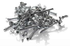
nachher Spanbildung mit High-Frequency-Turning
