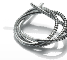
vorher Spanbildung mit herkömmlicher Bearbeitung
