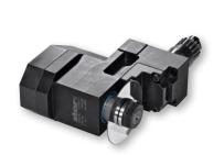
**7.076.165**Schlitzapparat Säge Ø 50 x 13 mm (Gegenspindel)
