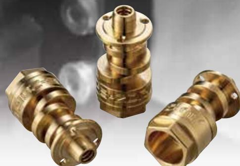
Für exzentrisches Drehen musste bisher das Material um den außermittigen Versatz mechanisch angepasst werden. Dadurch konnte auf Maschinen, die mit Stangenmaterial arbeiten, nur auf der Gegenspindel und nur mit Verwendung einer teuren Sonderzange exzentrisches Drehen realisiert werden.
