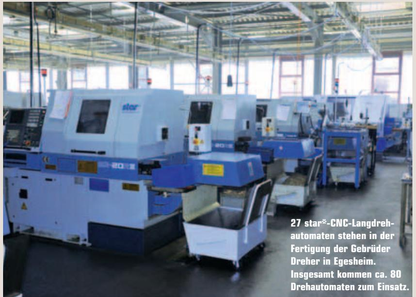
27 star\*-CNC-Langdrehautomaten stehen in der Fertigung der Gebrüder Dreher in Egesheim. Insgesamt kommen ca. 80 Drehautomaten zum Einsatz.
