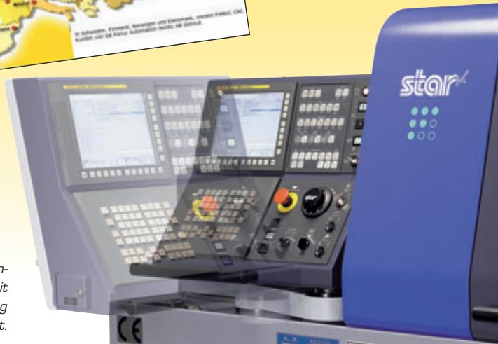
Der star\*-CNC-Langdrehautomat SR-20RIII ist mit der FANUC-Steuerung 300is ausgestattet.
