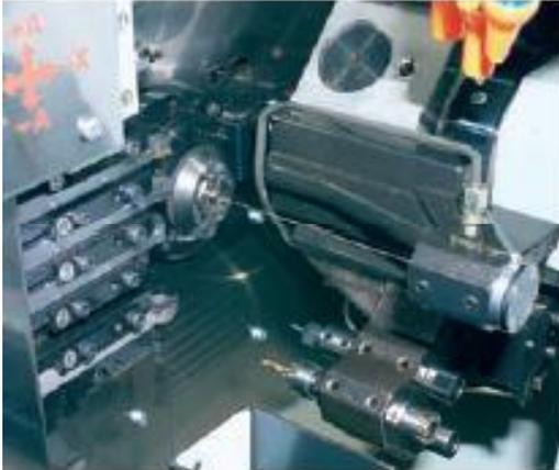
*Herstellungsprozess einer Aspirator-Spitze auf der SV-20 bei Integra. Fertigung einer Tieflochbohrung mit 1,5 mm Durchmesser in Titan mit einem Längenverhältnis zur Bohrung von 80:1*
