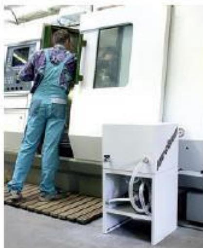
Der emu-cleaner reinigt und bereitet die Emulsion für den sicheren Betrieb der Zerspanungsmaschine auf und gewährleistet eine deutliche Standzeitverlängerung der Emulsion.
