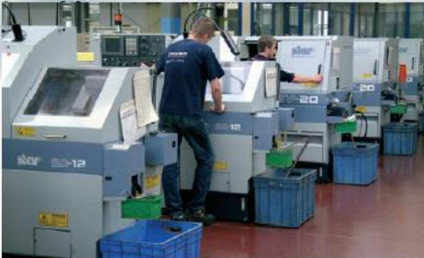
Hacker Feinmechanik GmbH verfügt über einen Maschinenpark mit über 100 CNC-Fertigungsanlagen, darunter 50 star\*-Langdreher. Bei dem ersten bei Hacker eingesetzten star\*-CNC-Langdrehautomaten handelt es sich um eine RNC-16A, die schon im Jahre 1989 geliefert worden ist. Heute werden in der Produktion noch etwa 10 Langdreher aus der damaligen Zeit eingesetzt und erfüllen noch immer täglich zuverlässig und mit höchster Präzision Ihr Soll.
