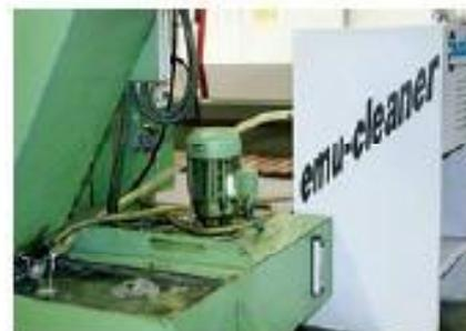
Der emu-cleaner wird einfach an die Kühlmittelanlage angeschlossen und befreit die Emulsion von Fremdölen, Schwebstoffen, Restschmutz und Spänepartikeln. Dies bietet bei Werkzeugen und Maschinen Schutz vor vorzeitigem Verschleiß und Beschädigungen. Gleichzeitig wird die Emulsion mit Sauerstoff angereichert, so dass ein höherer Wirkungsgrad erreicht wird.
