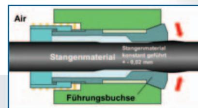
können Toleranzen besser eingehalten werden. Höhere Präzision durch eine flexible Führungsbuchse, realisiert durch eine robuste und – wie wir finden – geniale Konstruktion.
