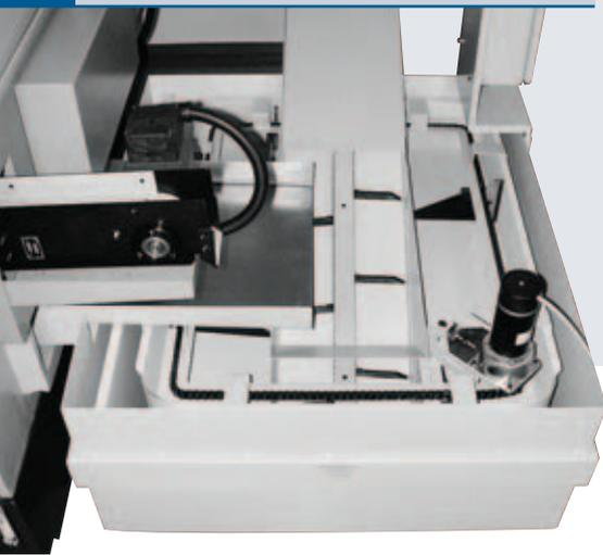
Kühlmittel und Feststoffe werden über eine Rutsche oder einen Ausschwemm-förderer aus der Maschine in das Ausschwemmbecken ausgebracht. Im Ausschwemmbecken trennen Schott- und Siebblecheinsätze sowie das integrierte Umlaufkratzsystem die groben Späne und Festpartikel vom Kühlmittel.
